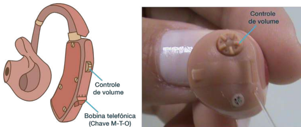
Figura 14 – Ilustra controle externo de volume e bobina telefônica em aparelhos auditivos:
