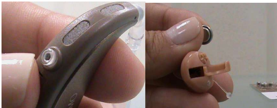
Figura 13 – Ilustra a chave de liga/ desliga em AASI retroauricular e intra-auricular, respectivamente.
