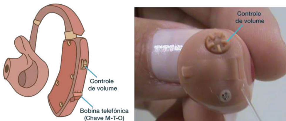
Figura 8 – Controle externo de volume e bobina telefônica em aparelhos auditivos: a) retroauricular; b) intra-auricular.
