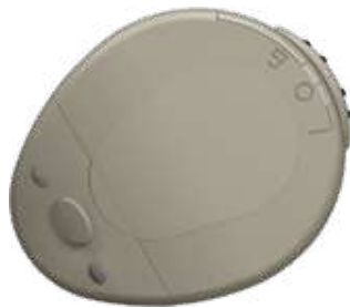
Figura 7 – RONDO processador de fala e antena em uma única peça.
