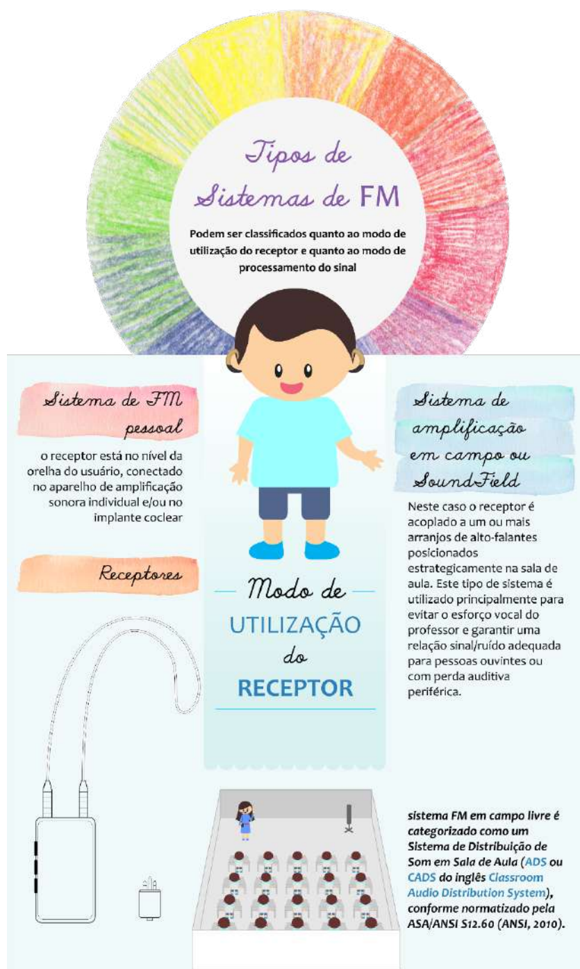
Figura 4 – Tipos de sistema FM de acordo com o modo de utilização do receptor.
