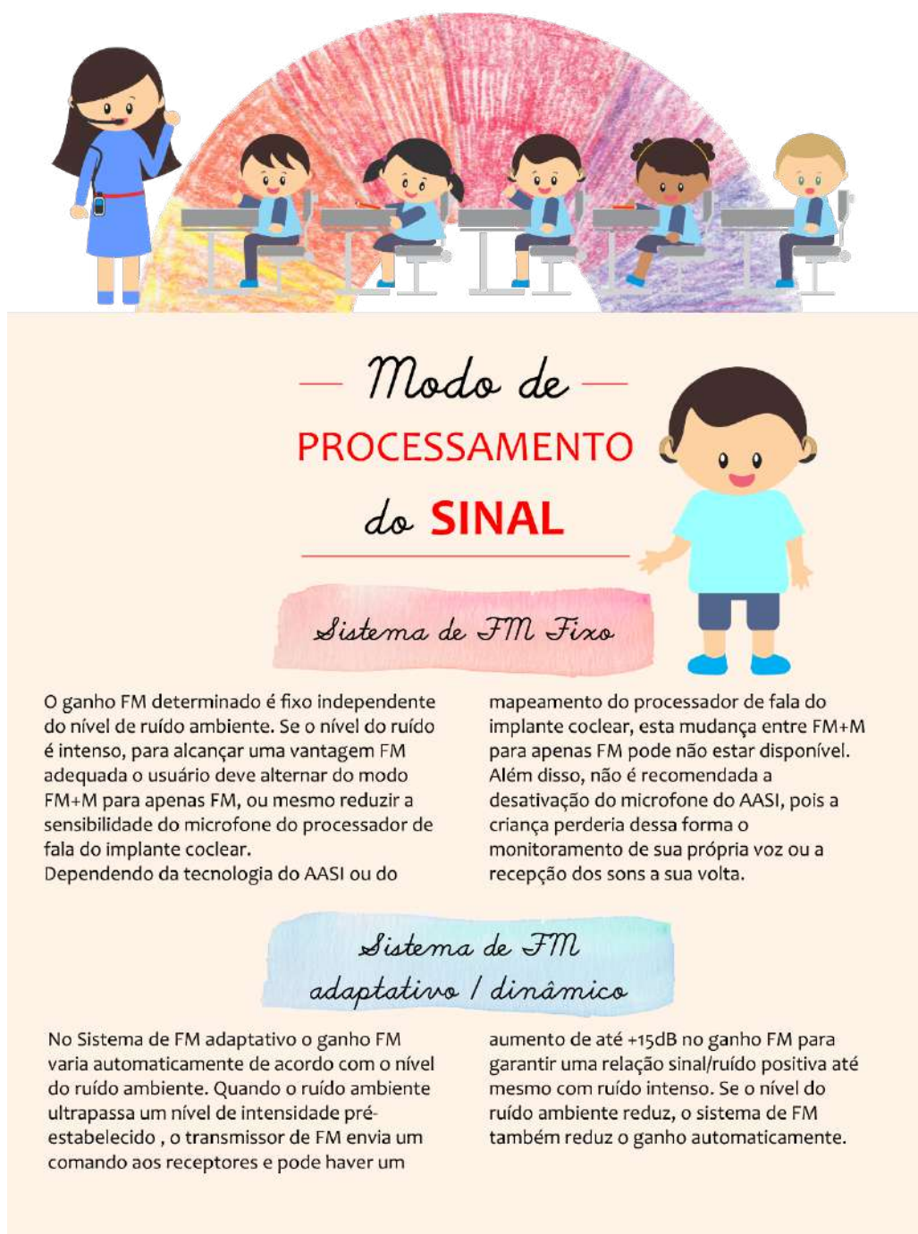
Figura 3 – Modo de processamento do sinal no sistema FM.
