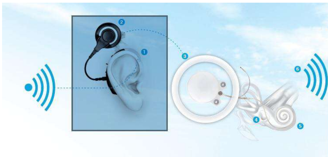
Figura 1 – 1. Processador de Fala; 2. Antena Transmissora e Cabo; 3. Receptor-Estimulador; 4. Feixe de eletrodos; 5. Nervo auditivo; 6. Informação elétrica que será enviada ao cérebro.
